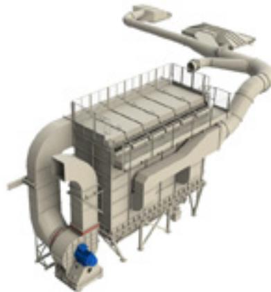
\* Система пылеулавливания на коксовыталкивателе «Usiminas», Бразилия
