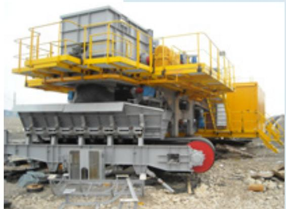
\* Приводная и реверсивная станция В1400, «Гацко»
