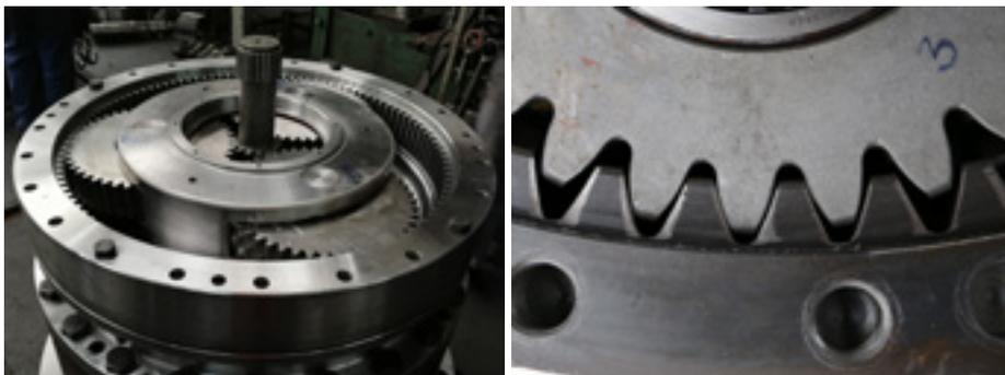
\* Сборка планетарного редуктора мощностью 45 кВт
