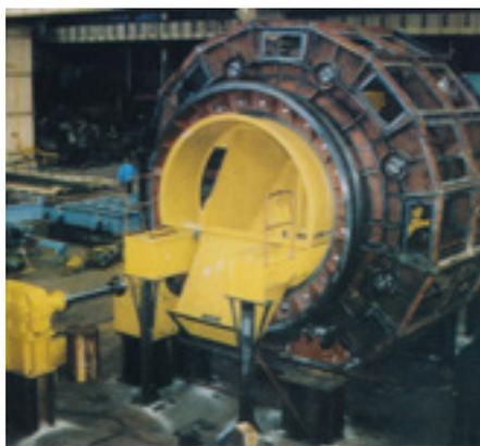
\* Установка грануляции жидкого шлака
