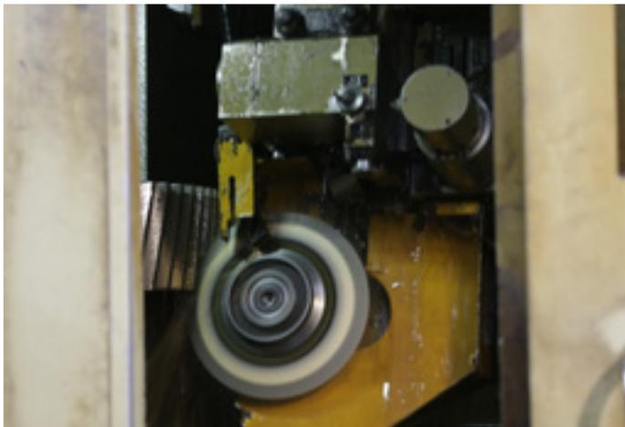
\* Шлифовальный станок для шлифования шестерен со спиральными зубьями W800 CNC
