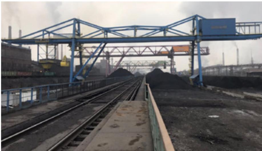
\* Грейферный перегружатель г/п 32 т, ОАО «ММК», Магнитогорск
