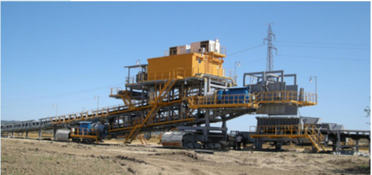
*\* Приводная и перегрузочная станция Б2000 Дрмно*
