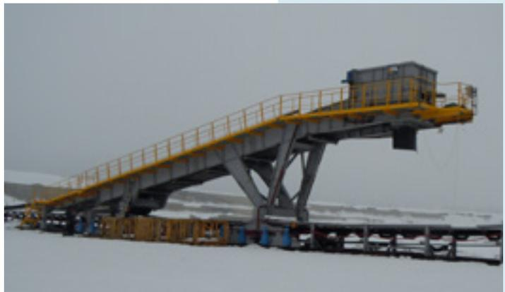
\* Перегрузочная тележка конвейера В1400, «Гацко»
