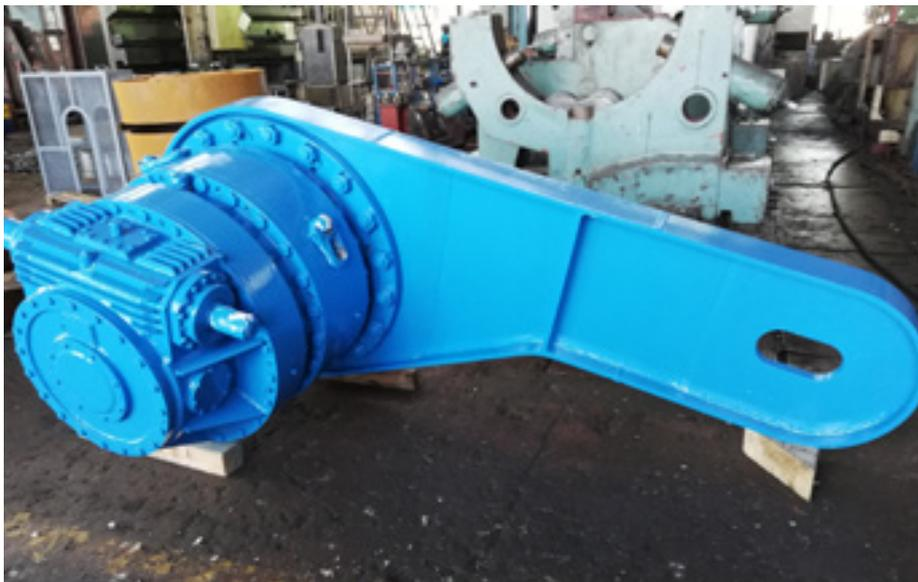
\* Планетарный редуктор  $P = 45$  кВт,  $i = 865$  для транспортировки приводной станции В2000
