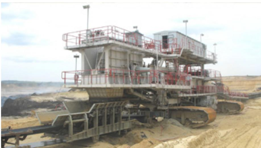
\* Приводная станция В1800 с мостом, ПК Дрмно
