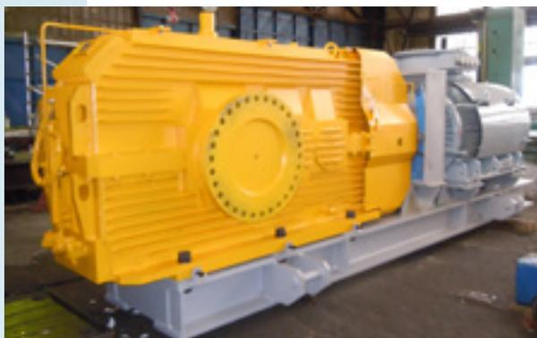
*\* Редуктор Р=1.000 кВт на этапе сборки привода*
