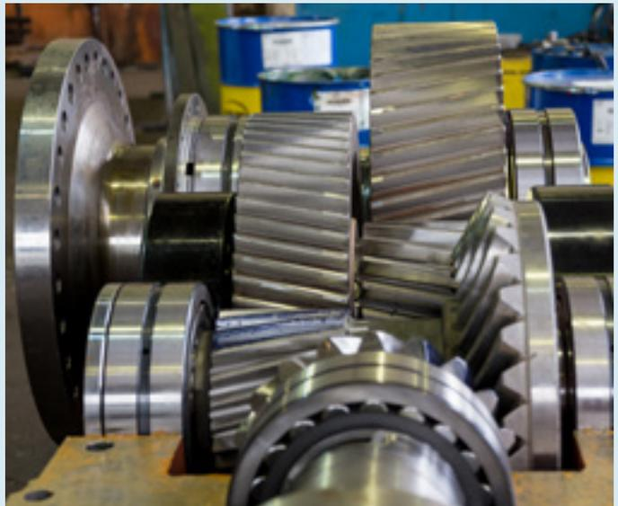
\* Внутренность коническо-цилиндрического редуктора
