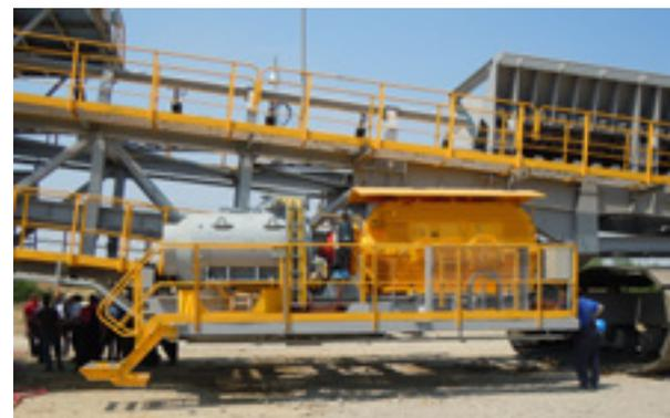
*\* Редуктор Р=1.000 кВт установлен на приводной станции Б2000*
