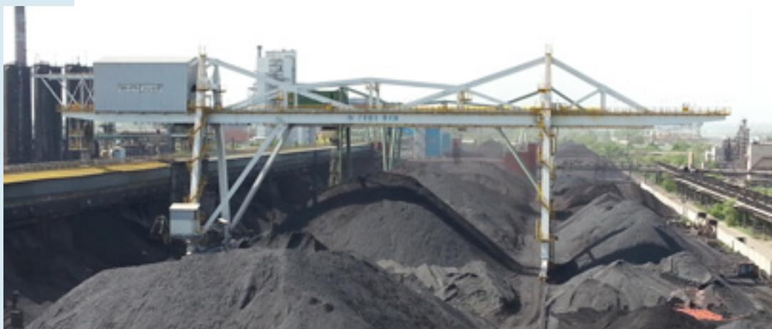
*\* Рудно-грейферный перегружатель угля г/п 32 т, ОАО «НЛМК», Липецк*
