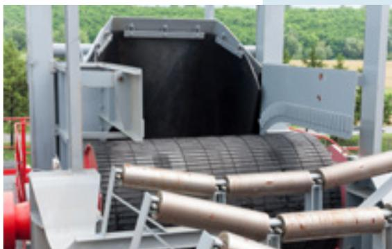
Приводной барабан  $\varnothing 1.500$  мм
