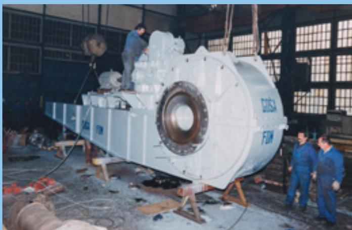
*\* Редуктор рабочего колеса экскаватора*
