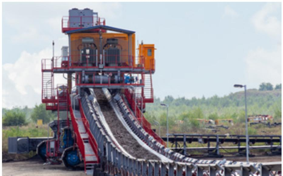
\* Приводная станция B2000 в работе «Дрмно»
