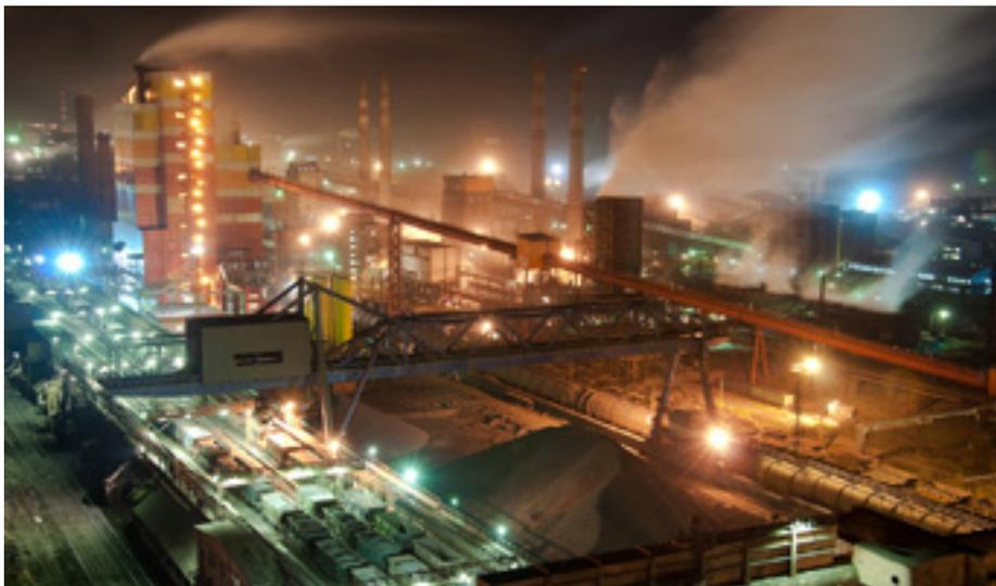
\* Рудно-грейферный перегружатель грузоподъемностью в 32 т ОАО «НТМК», Нижний Тагил
