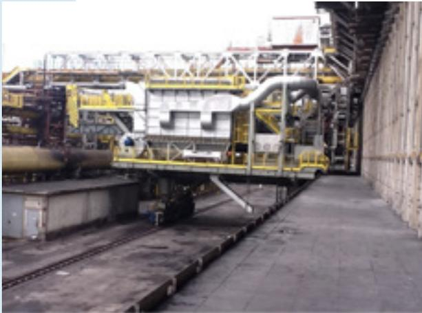
\* Коксовыталкиватель 37,8 м<sup>3</sup> с устройством пылеулавливания, «Usiminas», Бразилия
