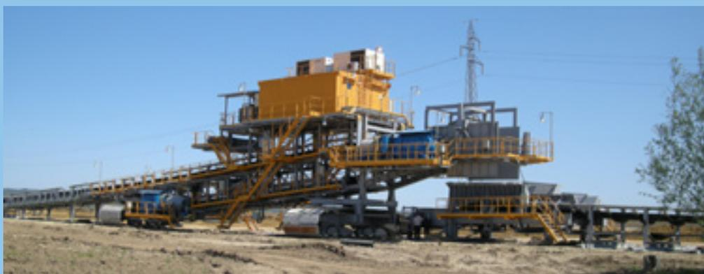
\* Приводная реверсивная станция
