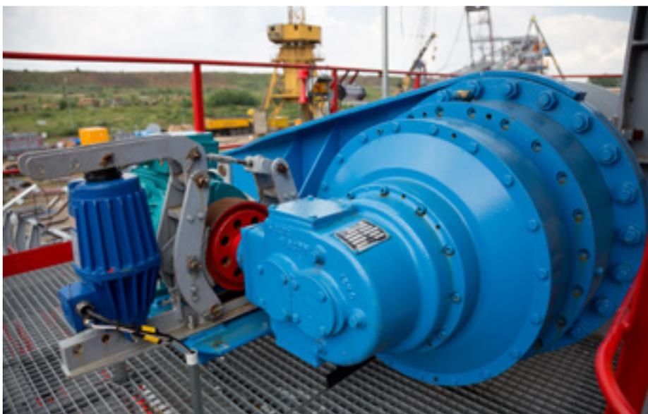
\* Планетарный редуктор для затяжки ленты приводной станции В2000,  $P = 15$  кВт,  $i = 945$
