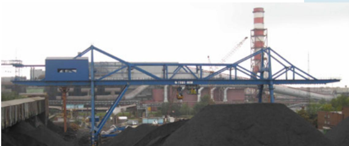
\* Грейферный перегружатель угля г/п 32 т, ОАО «Северсталь», Череповец
