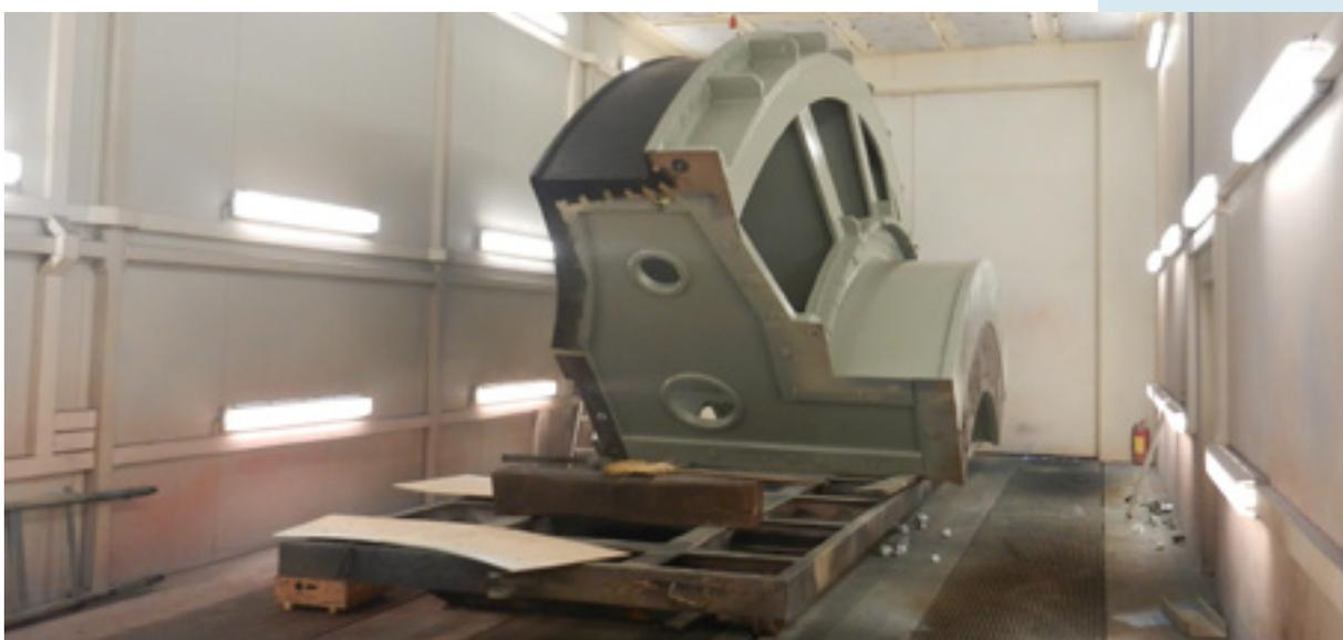
\* Покрасочная камера размером 12.8x25 м
