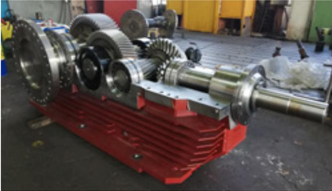
\* Коническая пара шестерен со Клингелнберг «цикло-паллоидным» винтовым зацеплением
