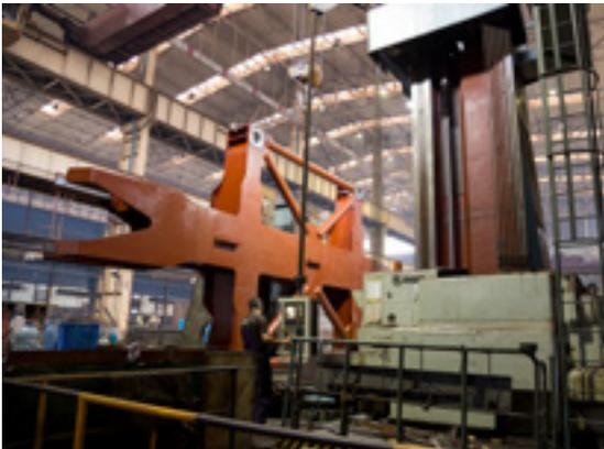
\* Горизонтальный сверлильный-фрезерный станок W200 HB CNC
