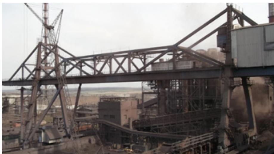
*\* Рудно-грейферный перегружатель г/п 32 т, ОАО «Тулачермет», Тула*
