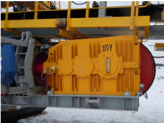
\* Привод конвейера  $P = 315$  кВт, «Гацко»
