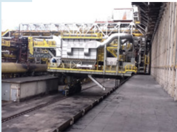
* Изгуривач кокса, 37,8 м 3 са системом усисавања прашине, „Usiminas”, Бразил
