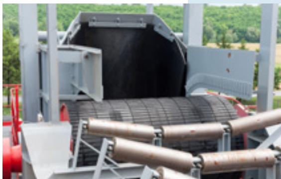
* Погонски добош \varnothing 1.500 \text{ mm}
