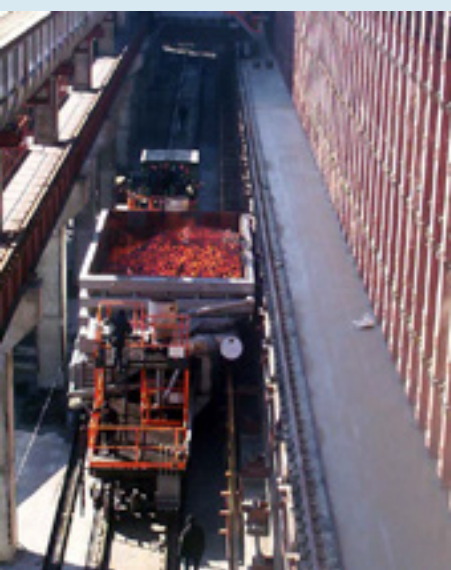
* Вагон за гашење с комбинованим гашењем (одозго и одоздо), 42,9 \text{ м}^3 , ОАО „Кокс”, Кемерово
