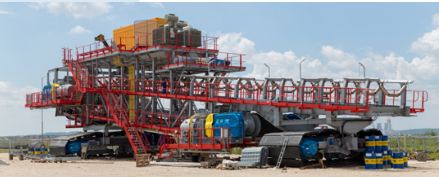
* Погонска станица B2000 на монтажном плацу „Дрмно-исток“
