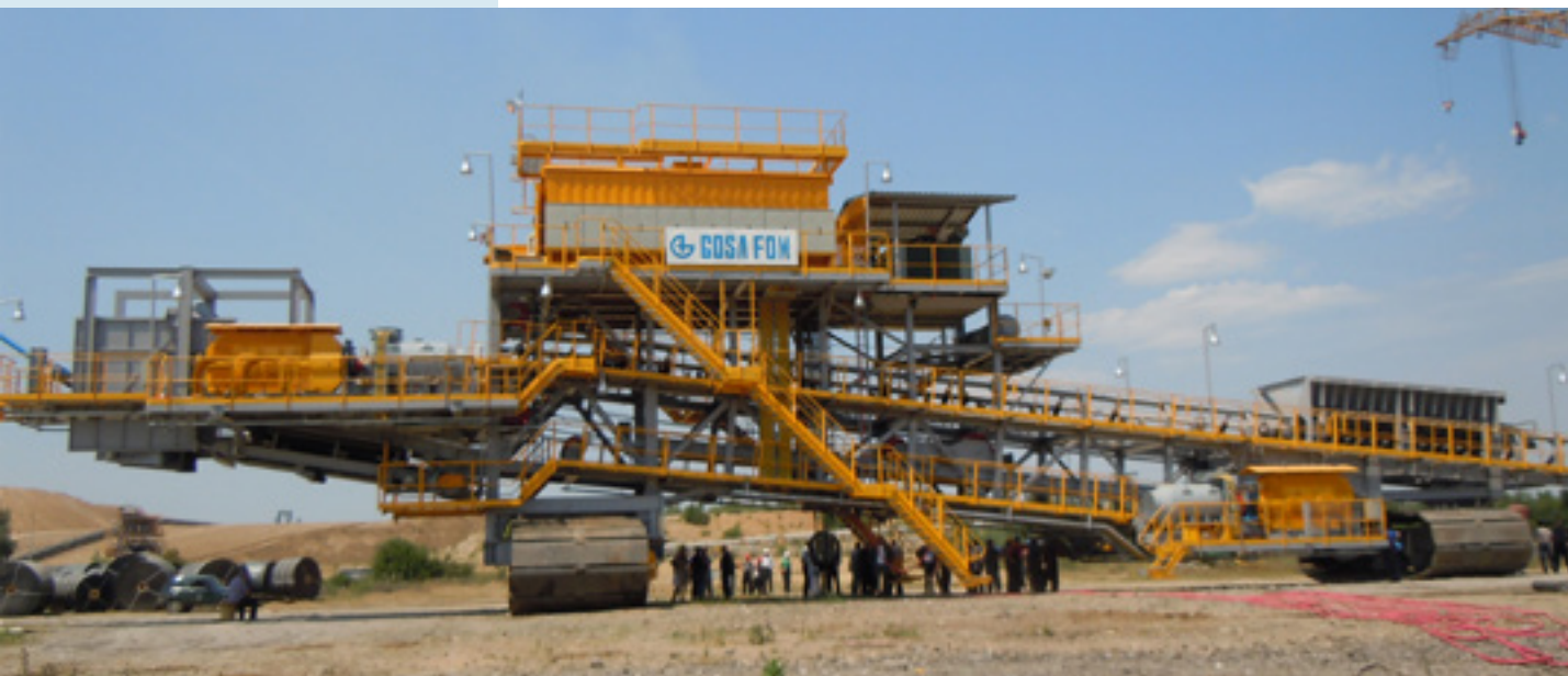
* Погонска станица Б2000 на монтажном плацу „Дрмно”
