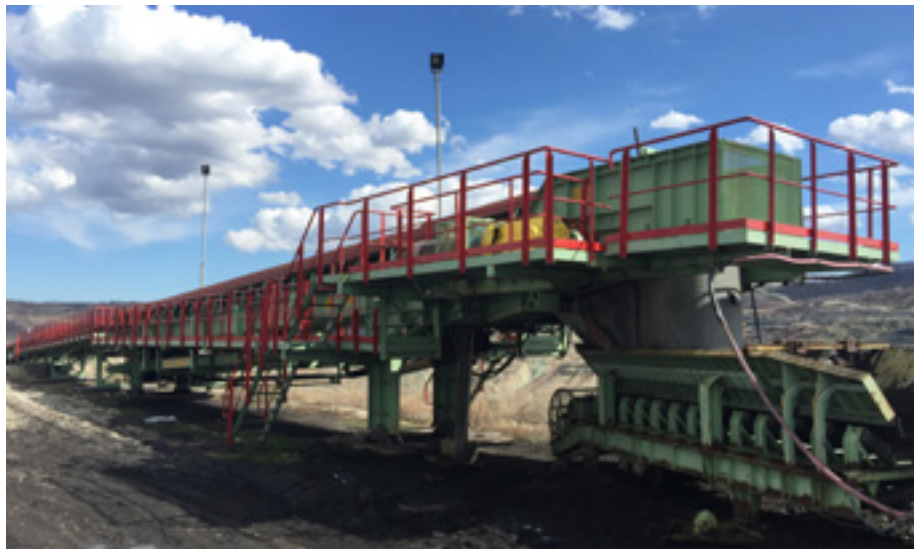
* Транспортни систем B=1000 мм, РиТЕ Угљевик - ПК Богutowo Село - БиХ
