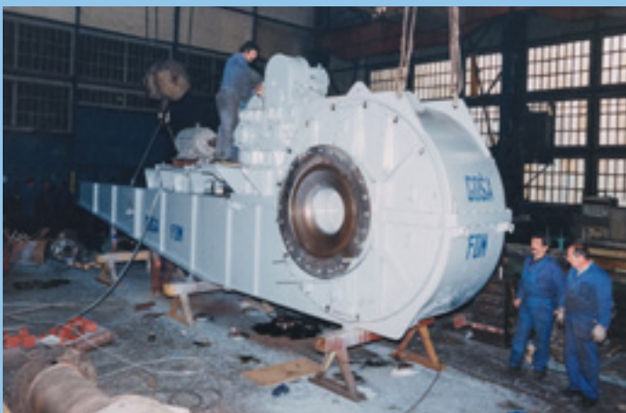
* Редуктор радног точка за багер SRs 1300
