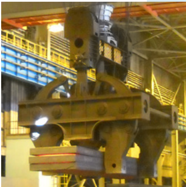
* Клешта за кран носивости 120 тона, ПАО „НЛМК”, Липецк
