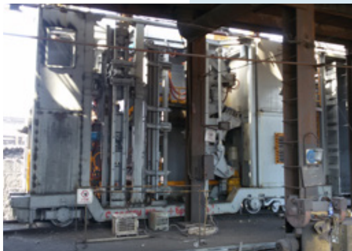
* Машина за скидање врата 21,6 м 3 , АО „Mittal Steel” – Темиртау, Казахстан
