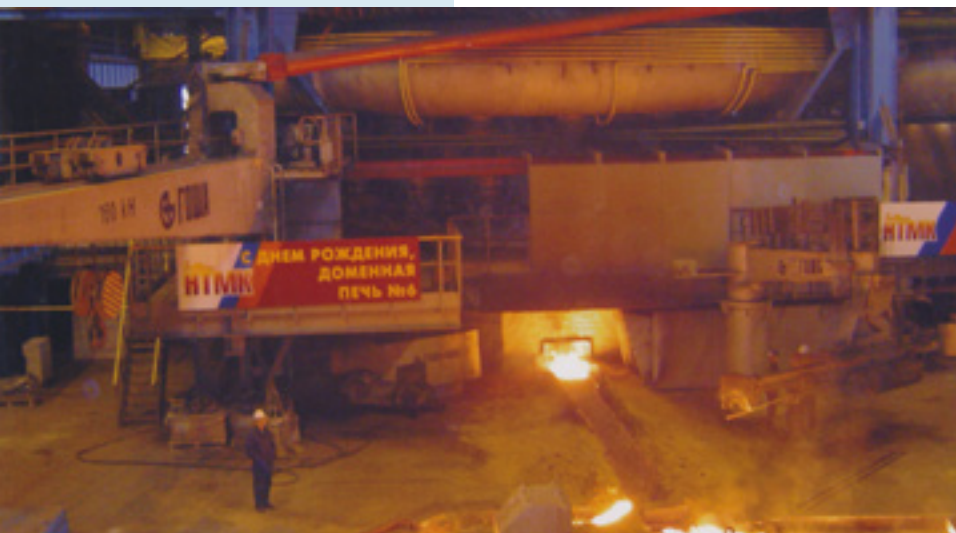
* Ливна платформа високе пећи, ОАО „НТМК“, Нижни Тагил
