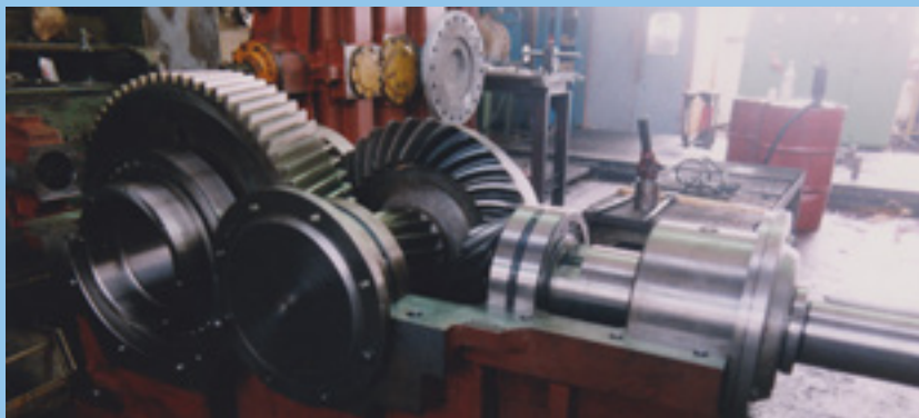
* Конусно-цилиндрични редуктор „ГОША” – „Eickhoff”
