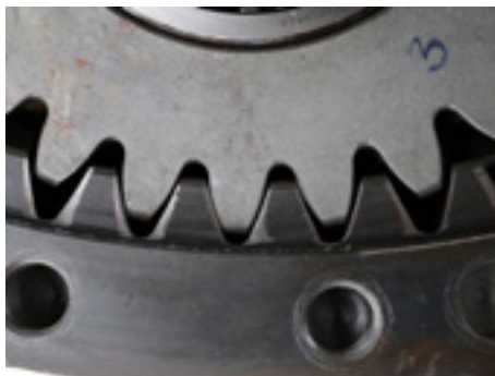
* Планетарни редуктор за затезање траке погонске станице B200, P = 15 \text{ kW} , i = 945
