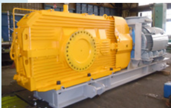
* Редуктор „P = 1.000 kW” у пробној монтажи
