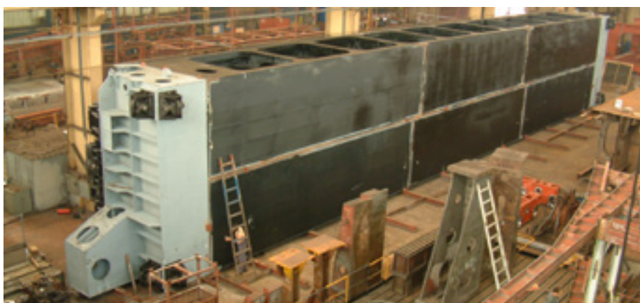
* ХЕ „Ђердап“, пробна монтажа табластих затварача бродске преводнице
