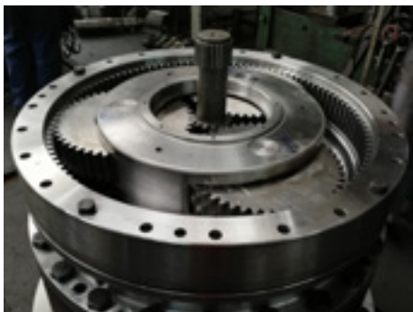
* Монтажа планетарног редуктора снаге 45 \text{ kW}
