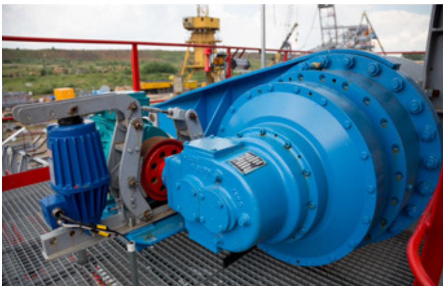
* Планетарни редуктор за затезање траке погонске станице B200, P = 15 \text{ kW} , i = 945
