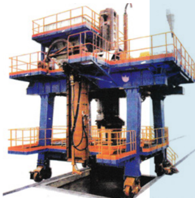
* Машина за облагање ливачких лонаца „Орбита”
