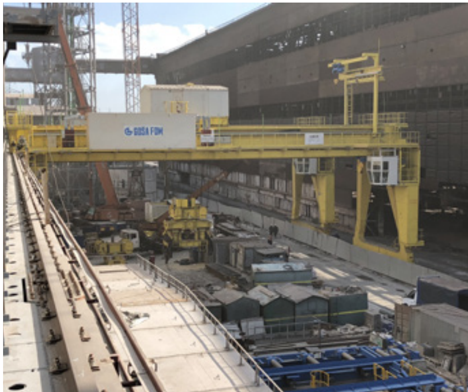
* Полупортална дизалица с клештима носивости 46 + 10 тона, ЧАО „ММК им. Иљича”, Мариупољ
