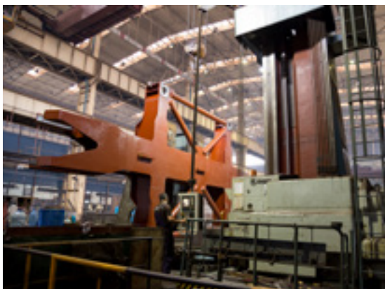
* Хоризонтална бушилица-глодалица W 200HB CNC
