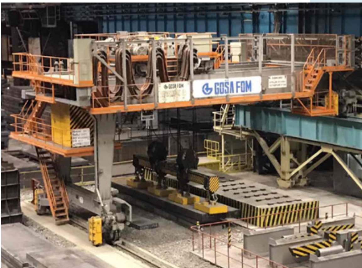
* Полупортална дизалица носивости 80 тона ПАО „НЛМК”, Липецк
