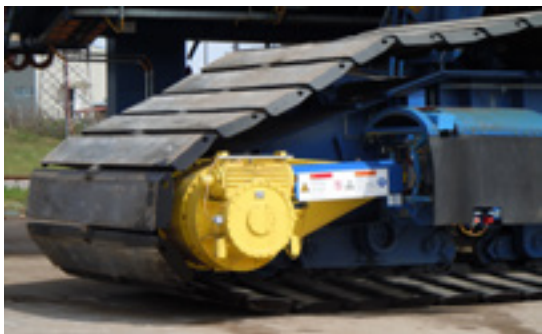
* Планетарни редуктор за погон транспорта одлагача „Sandvik”
