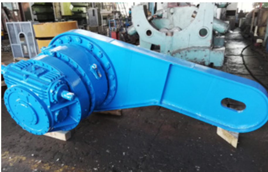
* Планетарни редуктор P = 45 \text{ kW} , i = 865 за транспорт погонске станице B2000
