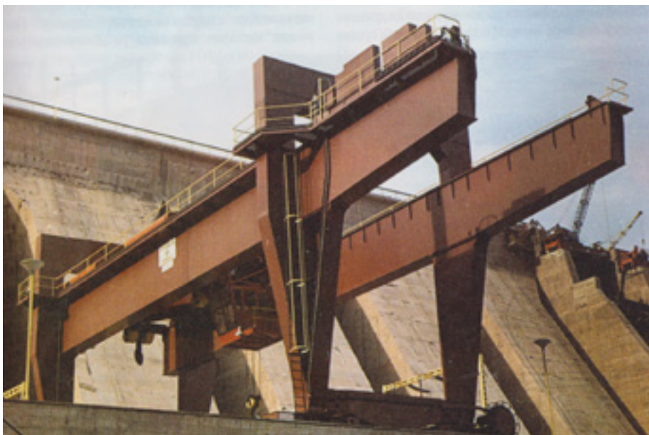
* Хидроелектрана „Бајина Башта” – портална дизалица носивости 2 x 175 тона
