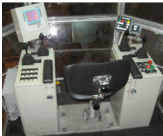
* Кабина оператора крана са клештима носивости 120т
