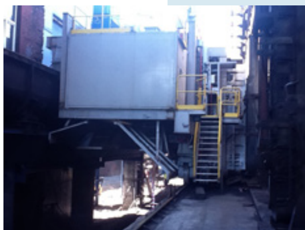
* Машина за скидање врата 21,6 м 3 , ПАО „Северстаљ”, Череповец
