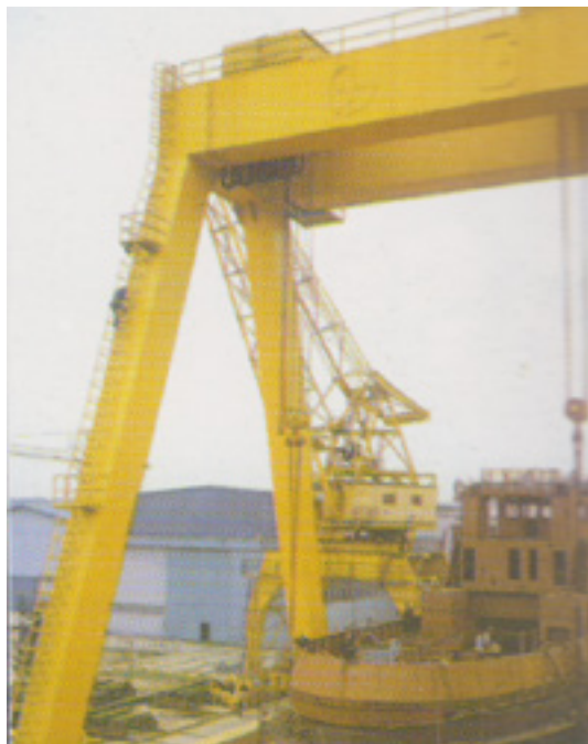
* Портална дизалица за бродоградилиште Београд, дужине 62 метра, носивости 100 тона
