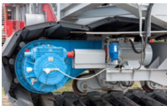
* Планетарни редуктор R = 45 \text{ kW} , i = 865
