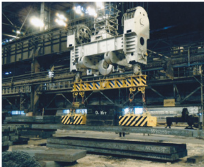
* Дизалица носивости на траверзи електромагнета 80 тона, ПАО „НЛМК”, Липецк
