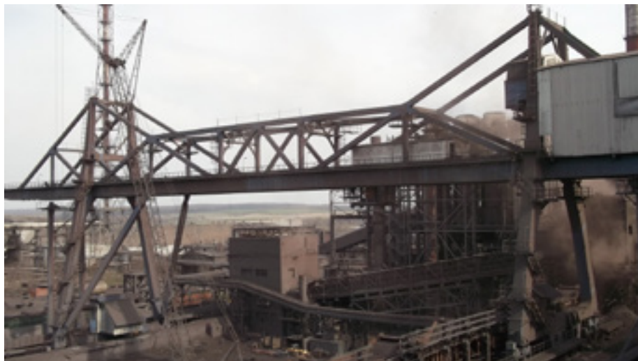
* Рудно-грабилични претоваривач носивости 35 тона, ОАО „Тулачермет”, Тула
