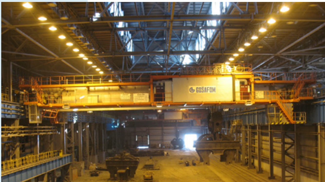
* Дизалица с клештима носивости 115 тона, ПАО „Северстаљ“, Череповец
