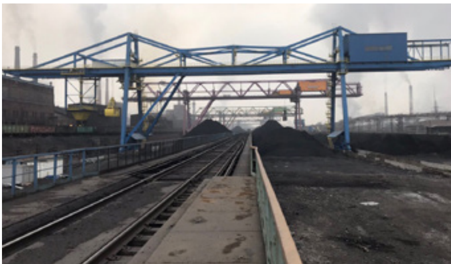
* Грабилични претоваривач за угаљ, носивости 32 тоне, ПАО „ММК“, Магнитогорск
