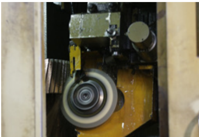
* Брусилица за брушење спиралних зупчаника W800CNC
